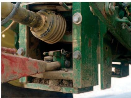
Der Piton-fix hat sich, verbunden mit dem Hitchring, als Untenanhängung bewährt. Bedingt durch das grosse Spiel, ist der Verschleiss hoch, insbesondere bei schweren Anhängern oder Ballenpressen.
