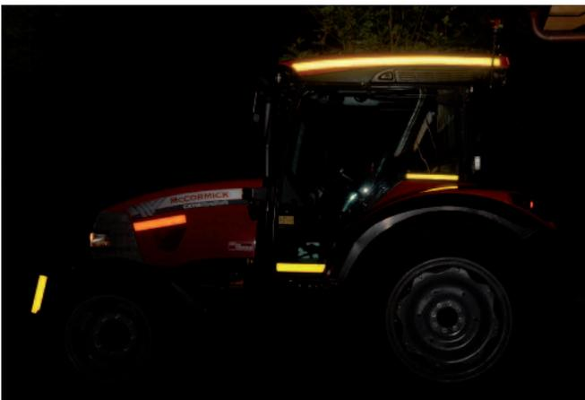
Traktoren und Anhänger sollen seitlich und hinten mit Konturmarkierung versehen werden, damit sie nachts und in der Dämmerung unübersehbar sind.
