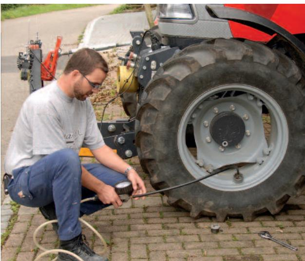
*Wichtig bei schweren Lasten ist der Luftdruck. Zu geringer Luftdruck mindert die Tragfähigkeit und führt zu hohem Reifenverschleiss und Unfällen. Eine automatische Reifendruckregelanlage sorgt dafür, dass der Druck für Feldarbeiten oder Strassenfahrten angepasst werden*
