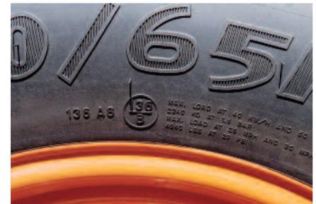
*Um die maximalen Lasten ausnutzen zu können, müssen Reifen, Achsen, Bremsen usw. die nötigen Anforderungen erfüllen. Die Reifenhersteller können Angaben zu den Kennzahlen liefern.*
