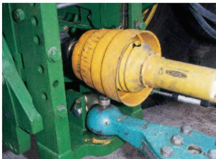
Die Untenanhängung mit der Kugelumkupplung ist die modernste und beste Lösung. Sie ist spielfrei und hat eine gute Verdrehbarkeit. Die maximale Stützlast von 3 t kann problemlos übertragen werden. Lohnunternehmer setzen vermehrt auf dieses System.
