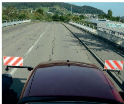
Doppelräder an Transportanhängern sind bis zur Breite von max. 3 m, ohne Bewilligung erlaubt. Sind sie mit Breitreifen mehr als 2,55 m breit, benötigen diese ein braunes Kontrollschild. Das Zugfahrzeug muss mit Doppelrädern, Breitreifen oder mindestens 60 cm breiten Reifen ausgerüstet sein. Eine Differenz muss auffällig am Traktor markiert sein.
