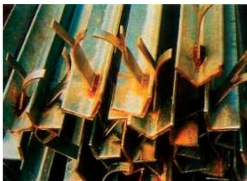
Abb. 18: Fehlstellen im Zinküberzug durch nicht entfernte Schweisschlacken
