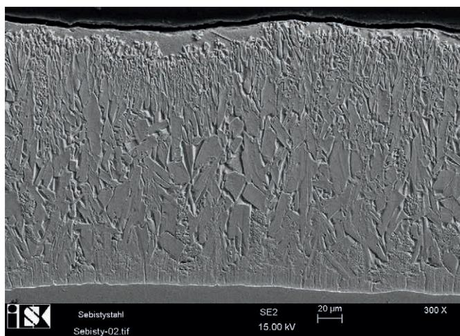
Abb. 2: Schlibbild feuerverzinkten Stahls mit typischem Schichtaufbau mit durchgewachsener Fe+Zn-Legierungsschicht; IKS Dresden
