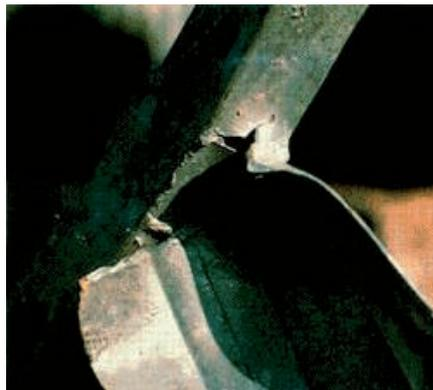
Abb. 9: Konstruktion aus Rechteckhohlprofilen, die im Zinkbad als Folge fehlender Bohrungen auseinander gerissen wurde.
